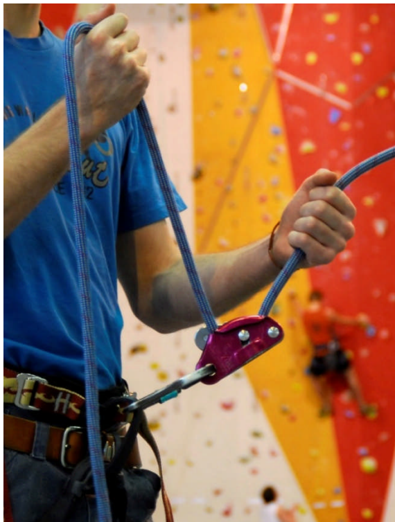
Abb. 4: Grigri - Seil falsch eingelegt – Notfall – Eingreifen nötig.
