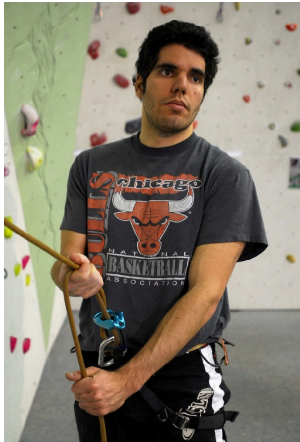
Abb. 4: Grigri - Seil falsch eingelegt – Notfall – Eingreifen nötig.
